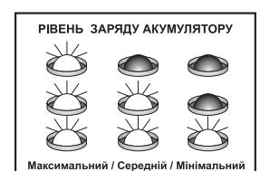
На Вашому виробі встановлені індикатори, які дозволяють контролювати міру заряду акумуляторної батареї. Для перевірки натисніть кнопку **9**. Індикатори **8** показують стан батареї.
